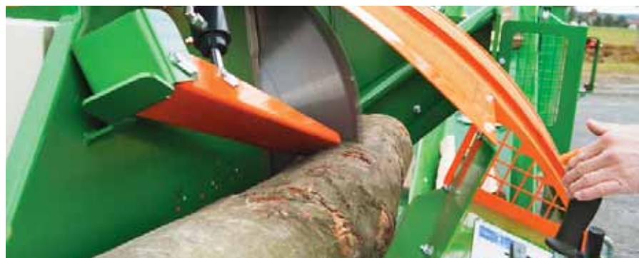
Vývojová novinka: hydraulický automatický držák dřeva v dolní poloze
