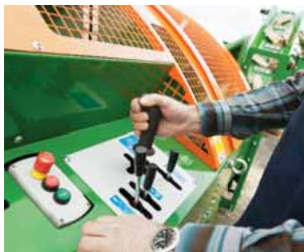
Obsluha a ovládání řízení u zařízení Spaltfix S-350 se provádí pohodlným pákovým jednoručním ovladačem.
