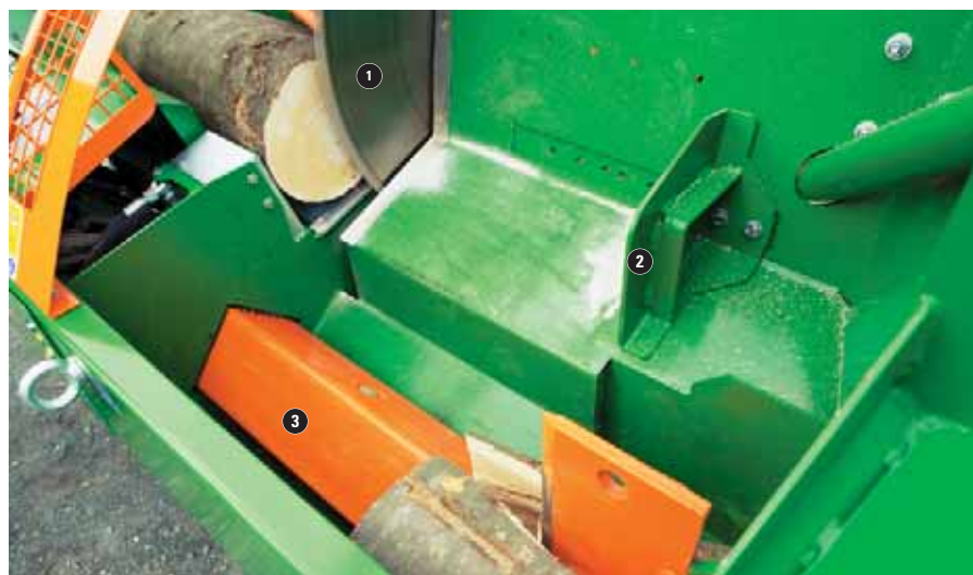
Vývojová novinka: hydraulický automatický držák dřeva v dolní poloze
