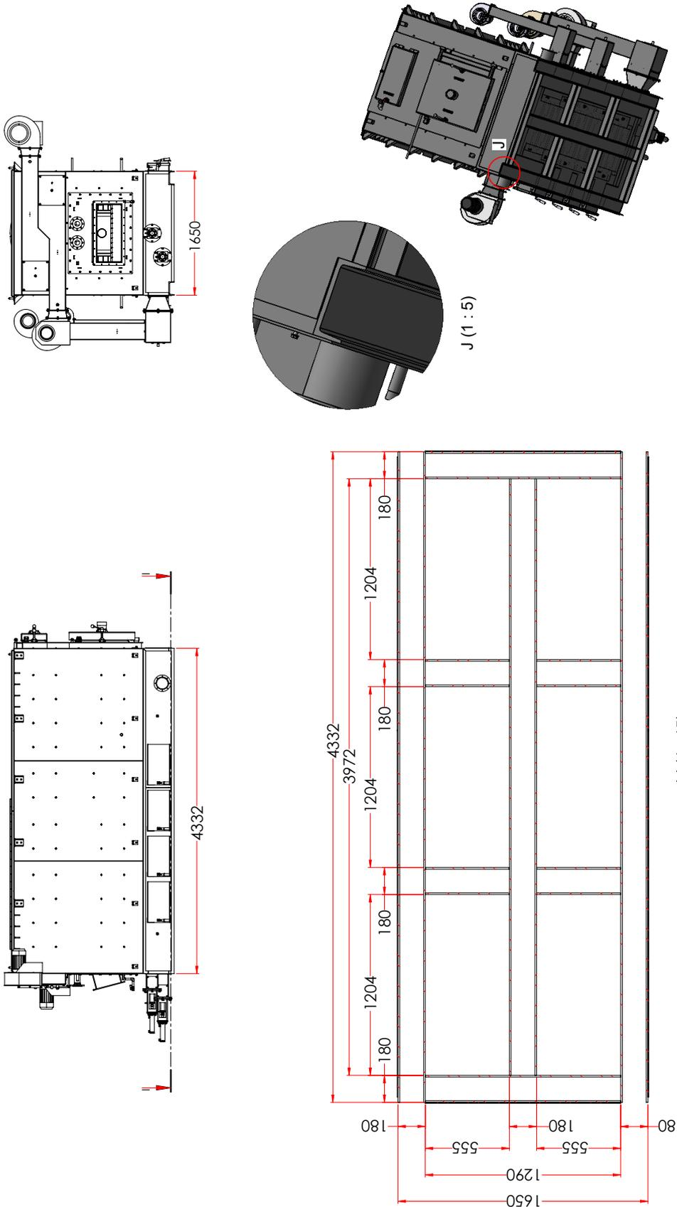
Der Grundrahmen des Kesselunterbaus ist aus U-Stahl 180x70 gefertigt
