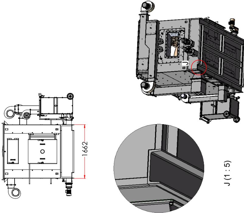
Der Grundrahmen des Kesselunterbaus ist aus U-Stahl 180x70 gefertigt
