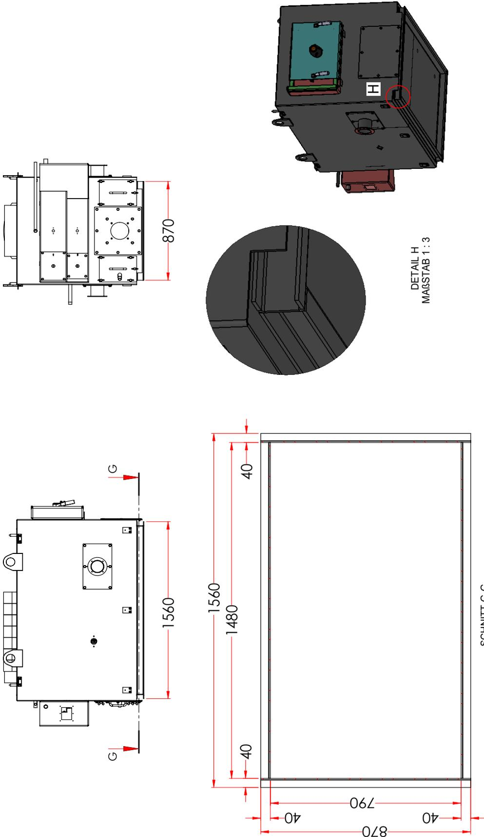
Der Grundrahmen des Kesselunterbaus ist aus U-Stahl 60x40 gefertigt
