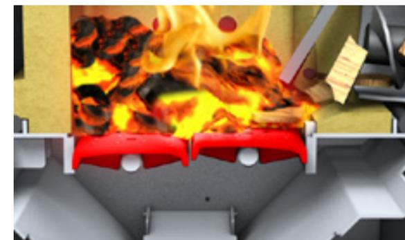
Geschlossene Roste in der Brennkammer mit hohem Glutbett – dadurch entsteht ein optimaler **Vergasungsprozess mit geringster Feinstaubentwicklung.**
