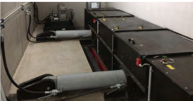
Massive Hydraulikzylinder zur Schubbodenbewegung
