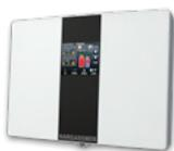
**Modul topných okruhů HKM:** Modul topných okruhů slouží k rozšíření topných okruhů a okruhů bojleru. Je zapojen do regulace celého kotle a ovládá až dva topné okruhy regulované směšovačem & jeden okruh bojleru s cirkulačním čerpadlem užitkové vody. Navíc lze připojit jeden externí topný okruh, resp. jeden zásobník a další HKM.
