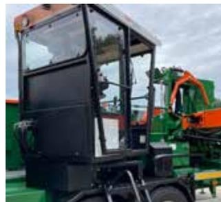
Die neue Kabine kann leicht geschwenkt werden, sodass Sie eine bessere Sicht auf die Sägeeinheit haben. Inklusive Bluetooth-Radio, Handyhalterung und Freisprechanlage.
