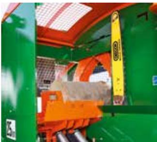
Dank der hydraulischen Ketten- und Schwertsprung und dem hydraulischen Doppelgreifer sorgt die SuperCut-Säge für einen sicheren und schnellen Schnitt. Die hydraulische Auswurfvippe übergibt den Stammabschnitt der Spalteinheit.
