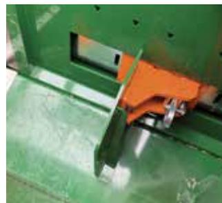
Sie definieren die gewünschte Scheitlänge (von 20 - 50 cm) – mit einem Handgriff und ganz ohne Werkzeug. Auch der Zugang zur Spalteinheit ist schnell und einfach möglich.
