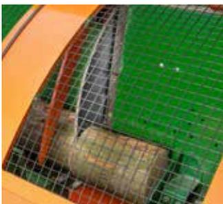
Das WIDIA-Hartmetall-Sägeblatt mit einem Durchmesser von 100 cm besticht durch seine hohe Standzeit und Langlebigkeit. Für ein sicheres Halten der Stämme beim Schnitvorgang sorgt der hydraulische Holzniederhalter.
