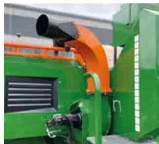
Sowohl der Ölkühler als auch der Kettenöltank sind nun größer ausgeführt.
