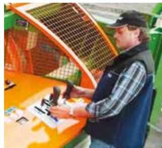
Mit dem 2-Hand-Joystick auf dem übersichtlichen Bedienpult liegen alle Prozesse sicher in der Hand. Über den Holzstammmanipulator werden die Stämme vor der Verarbeitung in die richtige Position gebracht.
