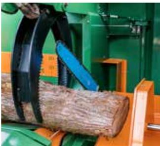
Das SuperCut-Harvester-Aggregat mit dem 100 cm langen Schwert und dem hydraulischen Doppelgreifer sorgen dafür, dass jeder Schnitt auch durch die dicksten Stämme sicher sitzt.
