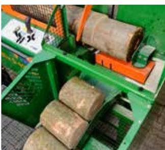
Der gekürzte Stammabschnitt wird über die hydraulische Auswurfwippe und die Stammrinne zum AutoSplit befördert. Das optionale Pufferband ist die ideale Zusatzlösung für den zügigen Transport von der Säge- zur Spalteinheit
