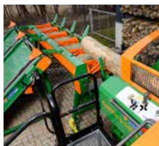
Der Stammeinzug zur Sägeeinheit erfolgt über das leistungsfähige Einzugsband. Stammauflagesysteme aus Längs- und Querförderern können nach Anforderung individuell kombiniert werden.
