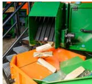
Beim Brennholz von 12–33 cm Länge ist die Scheitkantenlänge von 4–15 cm variabel einstellbar. Für optimales Anzündholz bis zu einer Länge von 20 cm sind auch feinere Scheite möglich. Auf Wunsch erhältlich: AutoSplit 650 für Brennholz bis 50 cm.
