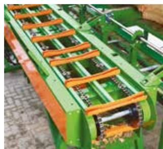
Die Doppel-Kettenförderer mit Holzmanipulator sorgen für eine beständige Verarbeitungsgeschwindigkeit. Kombiniert mit einem Holzauflegesystem schaffen Sie so mehr Raummeter pro Stunde.
