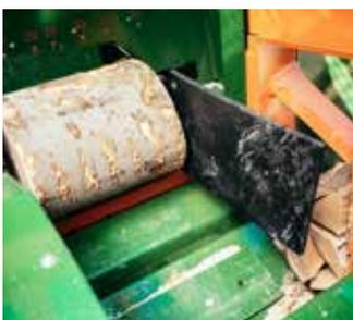
Der gesägte Stammabschnitt wird über die hydraulisch betätigte Holzwappe zum Spaltstempel befördert. Dieser drückt das Spaltgut gegen das Spaltmesser.
