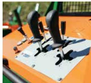
Sobald der Holzstamm das Einzugsband erreicht hat, lässt sich der Schneidspalt-Vorgang sicher und komfortabel über einen 2-Hand-Joystick steuern.
