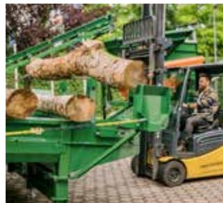
Die Beschickung ist jederzeit – auch im Automatikbetrieb – möglich. Dazu fährt das System im Eilgang retour und stoppt in der richtigen Position. Mehrere Sensoren überwachen den automatischen Beschickungsprozess, die Stammübergabe und die -vermessung.
