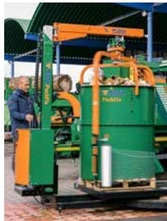
Der Rotationsarm umwickelt die Befülltrommel und die Scheite sicher mit dem Rundballnetz.
