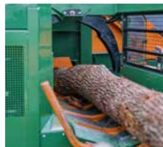
Je nach Holzmenge und Stammdurchmesser können Längs- und Querförderer individuell miteinander kombiniert werden. Der hydraulische Stamm-Manipulator sorgt dabei zusätzlich für eine optimale Stammposition.
