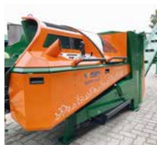
Der Sägespalter ist komplett pulverbeschichtet. Die Gusspumpe (anstatt bisher einer Alupumpe) sowie das stärkere Getriebe versprechen eine noch längere Lebensdauer. Die Ventile werden bei diesem Modell elektrisch gesteuert, dadurch entfällt der Tausch von mechanischen Verschleißteilen.
