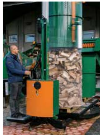
Die Trommel selbst dreht sich nicht mit und wird hydraulisch nach oben gezogen.
