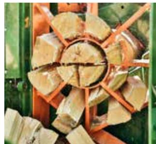
Das hydraulisch verstellbare MULTI-Rahmen-Spaltmesser kann bequem dem Stammdurchmesser angepasst werden und produziert ohne aufwändigen Messerwechsel pro Arbeitsgang 2, 6 oder 12 Scheite.
