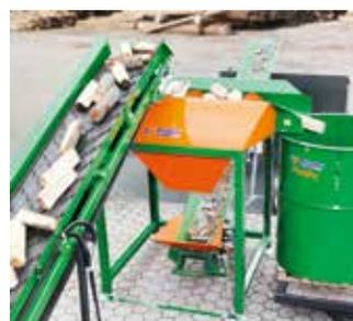
Die Förderbänder transportieren die fertigen Scheite zur gewünschten Verpackungslösung. Durch die Kombination des Holzreinigers LogFix und dem PackFix System bekommen Sie qualitativ hochwertiges und sauber verpacktes Brennholz.
