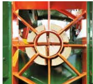
Das hydraulisch verstellbare MULTI-Spaltmesser sorgt für ein optimales Ergebnis bei jedem Stammdurchmesser. Bis zu 18 gleichmäßige Scheite produziert die Maschine so pro Arbeitsgang.
