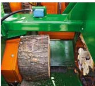
Das Druckstück drückt das Holz mit 35 t gegen das doppelschneidige Spaltmesser, und erzeugt so schnell die maximale Scheitanzahl.
