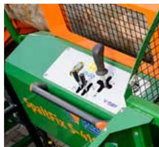
Von der Beschickung bis zum Schneidvorgang hat der Bediener alle Abläufe zentral im Griff. Krumme Stämme lassen sich mit dem optionalen Manipulator besser positionieren.
