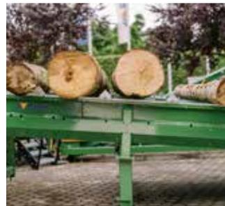
Auch krumme und große Stämme werden weitgehend störungsfrei verarbeitet, da diese durch Segmente getrennt sind und so einzeln zur Sägeeinheit befördert werden.
