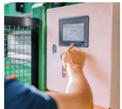
Über den Touchscreen der elektronischen Steuerung werden einfach die gewünschte Schnittlänge und die zulässige Längenabweichung der Scheite eingestellt.
