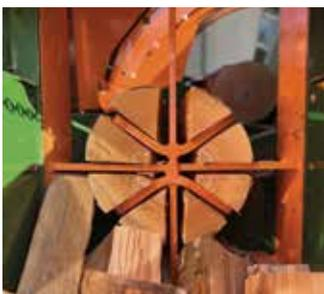
Der schräg ansteigende Spaltkanal gewährleistet eine sichere Übergabe nach dem Schnittvorgang. Die Spalthuboptimierung für kurze Holzlängen spart Zeit, da der Zylinder nicht mehr vollständig ausfährt. So schaffen Sie 25 % mehr Output bei Scheitlängen bis 33 cm.
