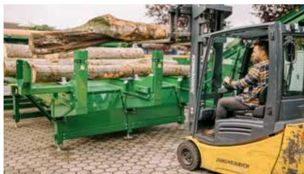
Die Blechverkleidung im Ladebereich verhindert, dass sich Spreißel und Schmutz unter der Anlage sammeln. Holzreste können so besser aufgefangen werden.
