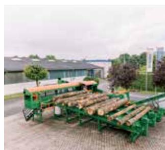
In Kombination mit dem SpaltFix K-710 a-Vario werden in maximal 90 Minuten bis zu 17 Stämme mit einem Durchmesser von max. 70 cm vollautomatisch verarbeitet. Der AutoFeed ist nachrüstbar.
