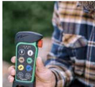
Sie steuern alle Funktionen bequem per Funkfernbedienung. Auf Knopfdruck bewegen Sie das Holz vom AutoFeed zur Sägeeinheit bzw. starten den Säge- und Spaltvorgang.
