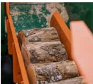
Die Anschlagwand am Pufferband ist 2-fach verstellbar, wodurch das Holz betriebssicher übergeben wird.
